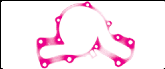
Carga desigual o insuficiente
